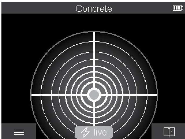
In der <**Spotansicht**> wird bereits ein erstes Messergebnis angezeigt, ohne dass das Messwerkzeug über dem Untergrund bewegt wird. Sie eignet sich deshalb besonders für Messungen in Ecken oder an Engstellen. Die maximale Messtiefe beträgt 6 cm. Gefundene Objekte werden gegebenenfalls mit Materialeigenschaft, aber ohne Tiefenangabe angezeigt.
